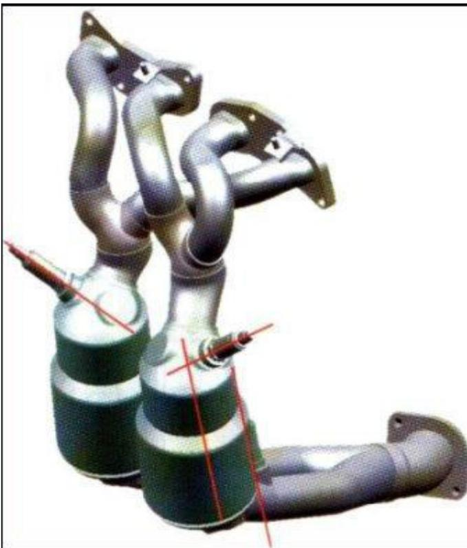
In pratica, si tratta dello stesso ottimo schema (conosciuto come "4 in 2 in 1") adottato anche sui Twin Spark, uno schema che rappresenta sempre la scelta ottimale per l'ottenimento delle migliori prestazioni del
